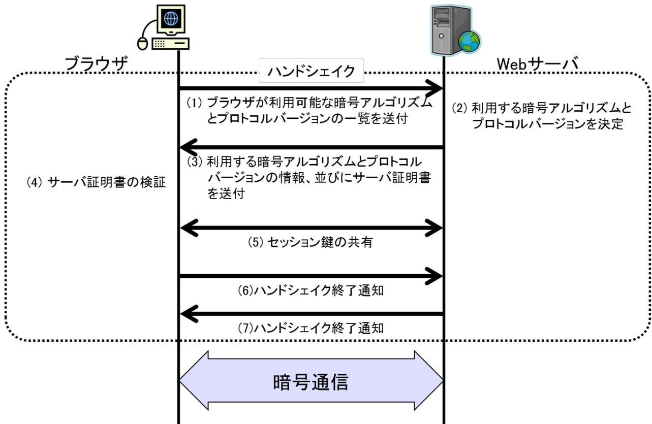
図 1 TLS プロトコル概要
