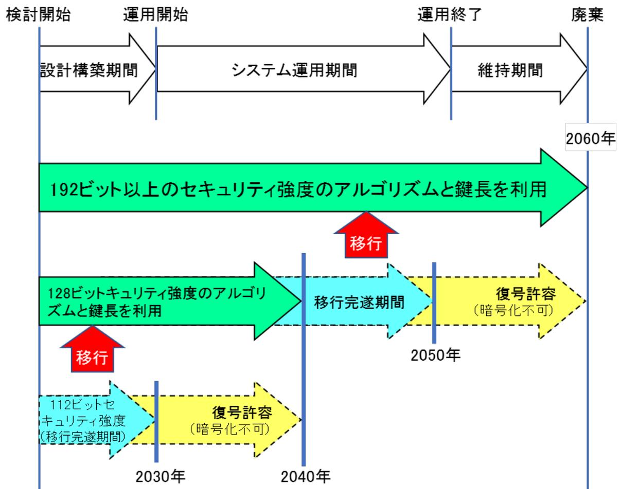
図 6 保管時の暗号化の例
