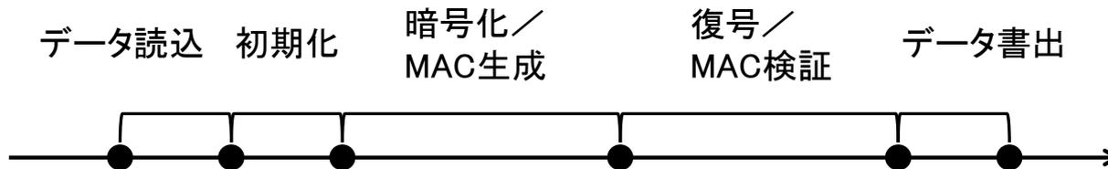
具体的には上図に示すように、データ読込、初期化、暗号化(MAC生成)、復号(MAC検証)、データ書出に掛る時間を測定し、次の測定値を出力する。
