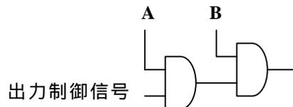
図 ハードウェアゲートの構成例
